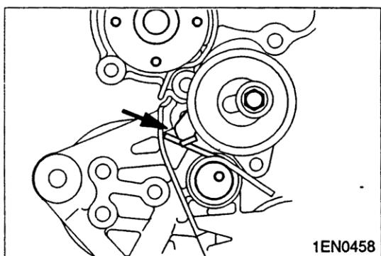
(3) 夹住张紧轮弹簧的另一伸长端，并如图所示将它钩到机油泵壳体凸耳上。
