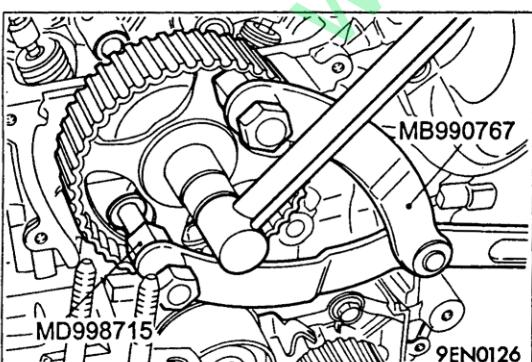
►B◄ 正时皮带张紧轮/张紧轮弹簧的安装
