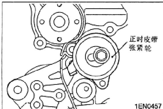
(2) 将张紧轮弹簧的一个伸长端钩在正时皮带张紧轮的钩形部，并将张紧轮装到机油泵壳体上。
