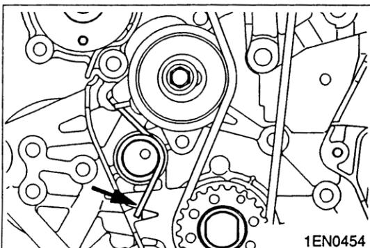
►B► 凸轮轴正时齿轮螺栓的拆卸
